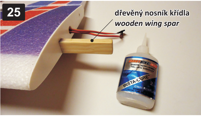
Důležité! Konce dřevěných nosníků křídla naimpregnujte napuštěním řídkým CA lepidlem jako ochranou proti vlhkosti a vodě. Přečtěte si text v úvodu návodu! Important! Impregnate ends of the wing wooden spars with the thin CA to protect wood against humidity and water. Read text at the start of this manual!
