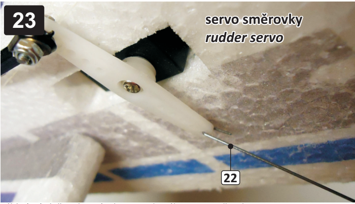
Táhlo (22) vložte ohnutým koncem do páky serva směrovky. Insert the pushrod (22) with U - bend into the rudder servo arm.
