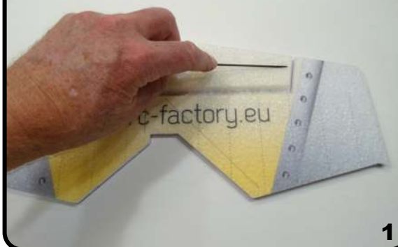
Locate the 3x0.5x250mm spar
