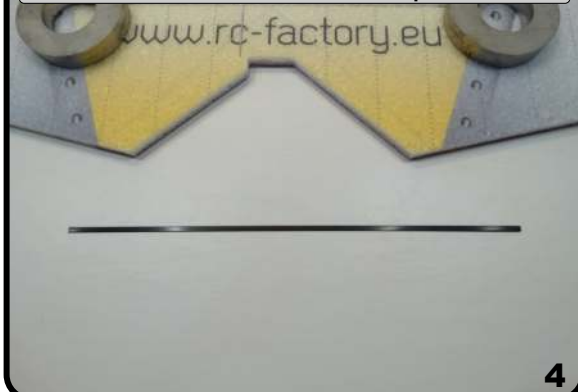
Locate the 3x0.5x250mm spar
